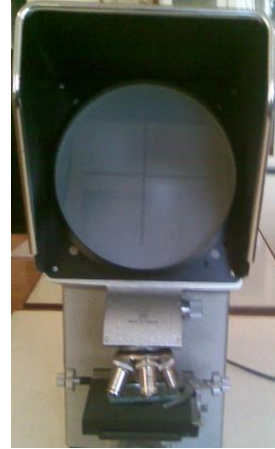
Şəkil 50. MP-3 markalı proyeksiya mikroskopu
