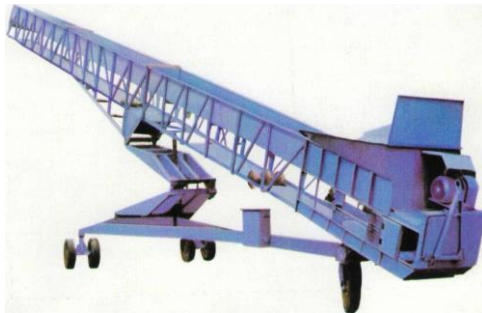
Şekil 7. KJIII - 650 markalı səyyarı lentli konveyer
