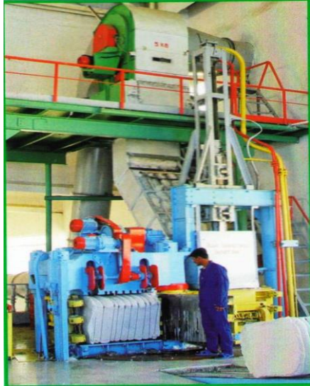
Şəkil 19. Pambıq mahlıcını kip şəklinə salınması
