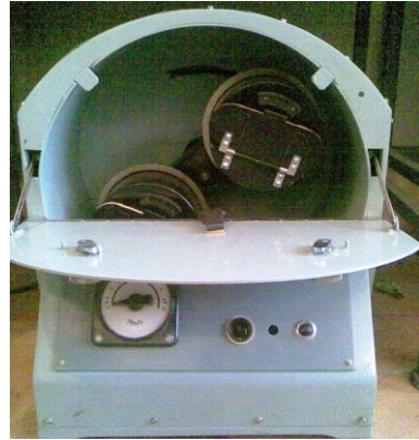
Şəkil 12. OOC-1M markalı mexaniki lif çıxaran cihaz
