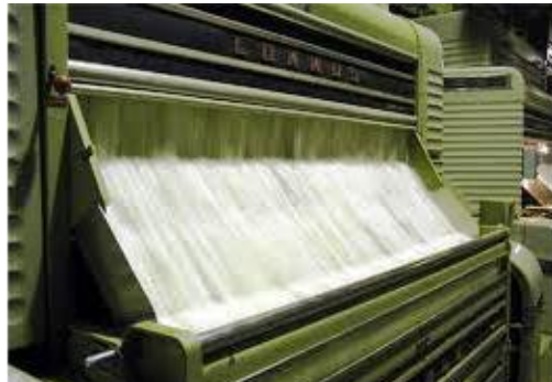
Şəkil 15. Pambıq lifinin yumşaldılması
