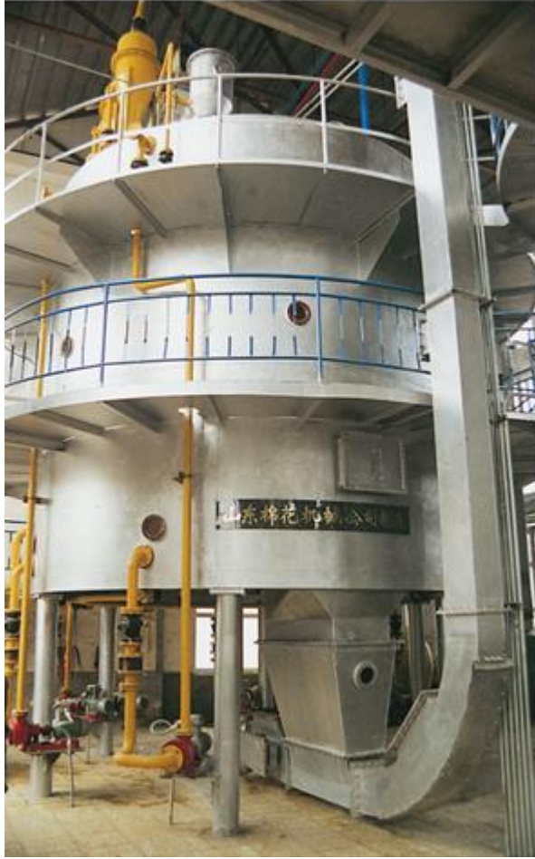
Şəkil 16. Pambıq toxumundan yağ çıxaran avadanlıq
