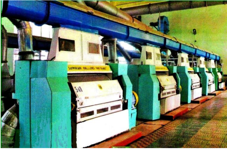
Şəkil 35. 5JIII markalı mişarlı linter maşınları
