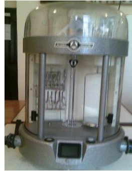
Şəkil 57. “WA” - 31 tipli analitik tərəzi
