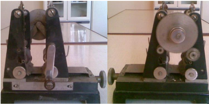
Şəkil 45. Laboratoriya üçün kiçik Jukov cihazı (hər iki tərəfdən görünüşü)
