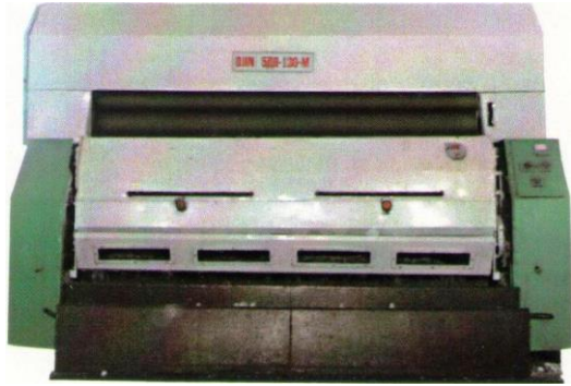
Şəkil 18. 5 ДП-130 markalı mışarlı cin
